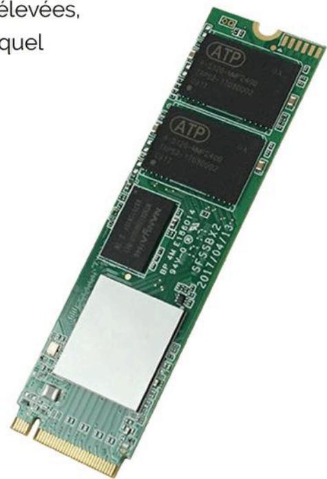
ATP démarre ce nouveau protocole standard industriel au sein de sa toute dernière ligne de SSDs au format M.2 2280. Les modules SSD NVMe ATP tiennent sur un seul slot PCIe Gen3 x4, délivrant ainsi une bande passante de 32Gb/s (8Gb/s par ligne) et de hautes vitesses de lecture-écriture séquentielle. Avec une gamme de température opérationnelle de -40 à +85°C, les SSDs NVMe offrent des performances égales même pour des températures extrêmes. La régulation thermique dynamique
